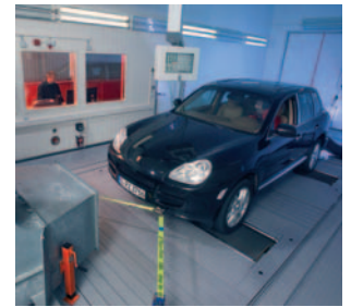
Les caractéristiques de démarrage à froid des bougies d'allumage sont testées sur le banc d'essai à deux axes dans le centre de recherche et de développement BERU à Ludwigsburg.
