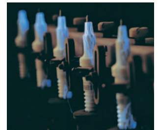
Contrôle d'isolateur sous 40 000 volts : Sur banc d'essai, les bougies d'allumage BERU doivent faire preuve de leur fiabilité avant le lancement de la fabrication en série.
