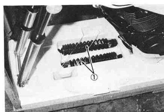
1. Rear shock absorber 1. Amortisseur AR 1. Hinterrad-Stoßdämpfer
