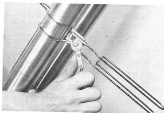
Installer le plateau porte-segments assemblé dans le moyeu de la roue avant.
